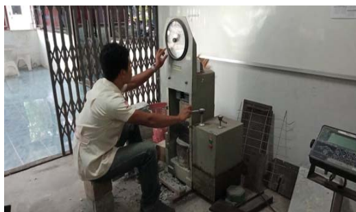
ภาพที่ 10 การตั้งค่ามาตรวัดสำหรับการทดสอบและการอ่านค่ากำลังอัด
