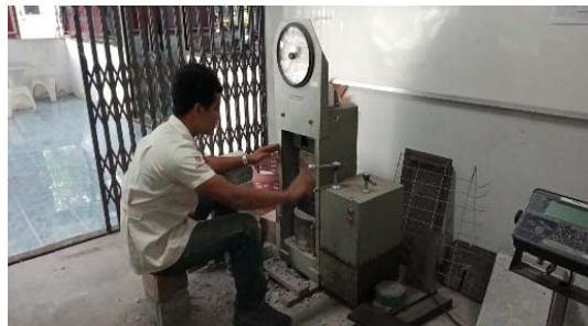
ภาพที่ 9 นำตัวอย่างทดสอบเข้าเครื่องทดสอบความต้านทานกำลังอัดคอนกรีต
