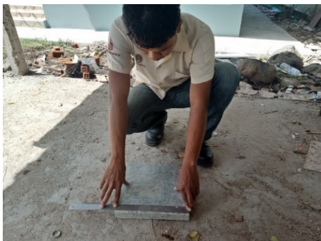
ภาพที่ 6 การทดสอบมิติของตัวอย่างทดสอบ
