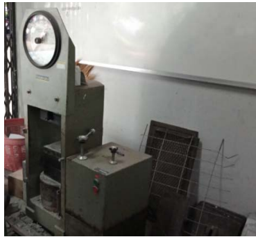
ภาพที่ 7 เครื่องทดสอบความต้านทานกำลังอัดคอนกรีต
